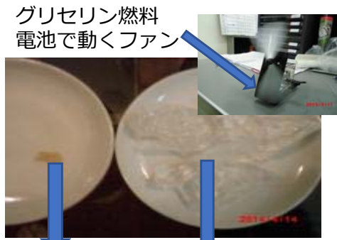
吸水前 吸水後 グリセリンから製造したポリ アクリル酸超吸水ポリマー
